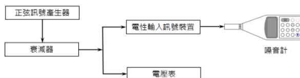
圖 7 噪音計位準線性度檢測系統
